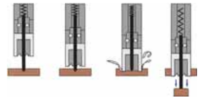
положение направляющего штифта на отметке
